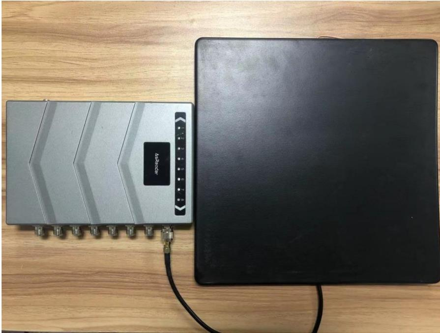
**注意：**ケーブルのコネクタの接続が正しく行われていない場合、信号が減衰し、RF タグの読み取り/書き込み性能が低下します。
